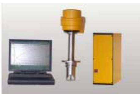
Stanowisko pomiarowe RHEOTEST® PR 4.1
