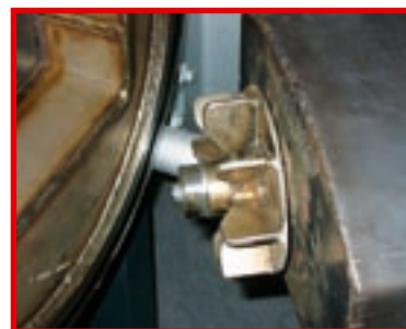
Fragment mieszalnika wewnętrznej atmosfery pieca PKRC
