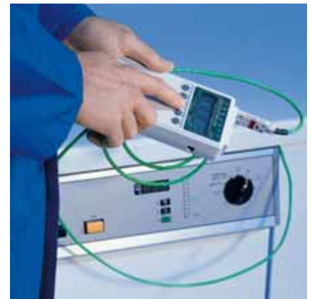
Dostęp do pomiarów w celu autonomicznej kontroli czasu utrzymywania temperatury
